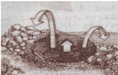
แยกดินชั้นบนและดินชั้นล่างไว้คนละกอง
